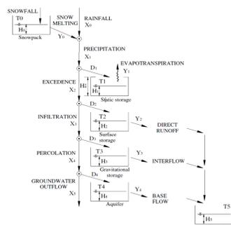
Figure 1. Scheme of the TETIS model (Francés et. al, 2007).
