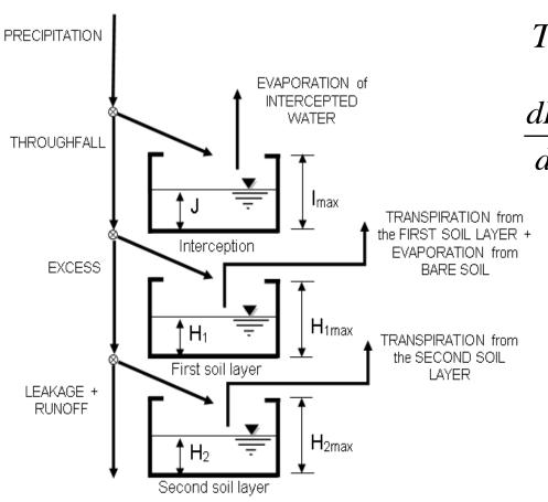
$$T_{1} = ET_{o} \cdot f_{t} \cdot \min(LAI, 1) \cdot \beta_{t}(H_{1}) \cdot r_{1}$$
